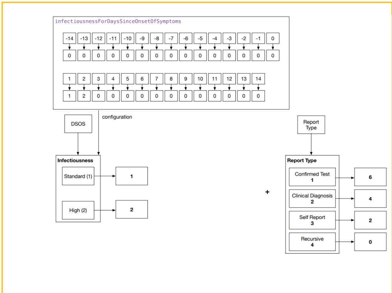
Abbildung 42: Berechnung des Transmission Risk Levels unter Verwendung des ENF V2<sup>33</sup>
