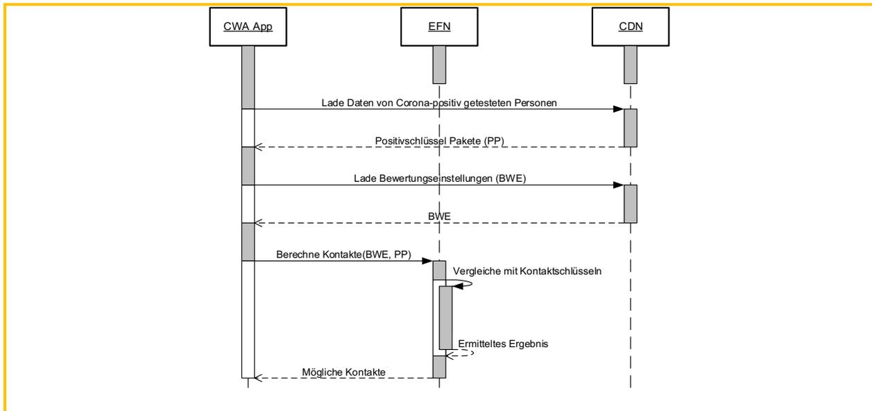
Abbildung 25: Laden der Positivschlüssel-Pakete und Ermittlung möglicher Kontakte
